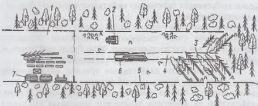
2.13-расм. Йўл минтақасини дарахтлардан тозалаш: 1-айирувчи майдонча; 2-тўнка олувчи; 3-ағдарилган дарахтлар; 4-кесилган дарахт уюми; 5-ажратилган дарахтни кесиш чегараси; 6-тортувчи трактор; 7- тўпланган дарахт; В-кесиш кенглиги.
