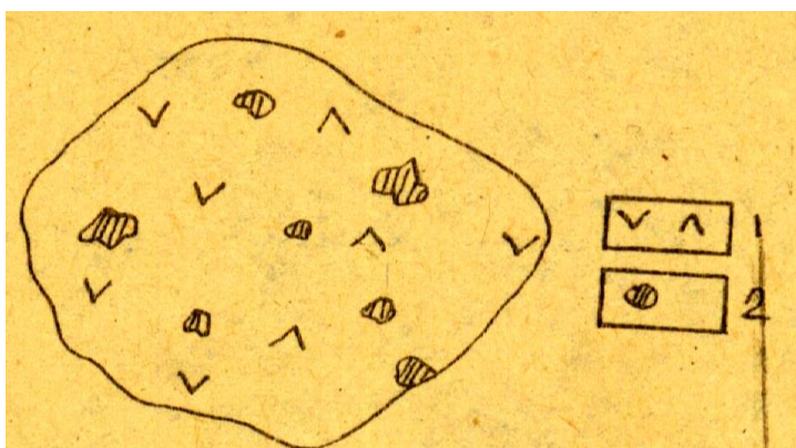
15-rasm. Qalmoqqir mis-molibden konidagi xollanma rudaning ko'rinishi. SHartli belgilar: 1-sienit-diorit; 2-xalkopirit minerali.
