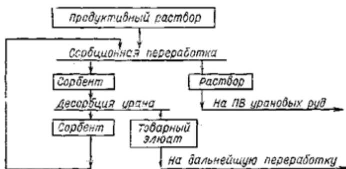
Расм.8.9 Yer ostida ishqorlashda mahsuldor qorishmalarni sorbsilovchi qayta ishlashning prinsipial texnologik sxemasi.
