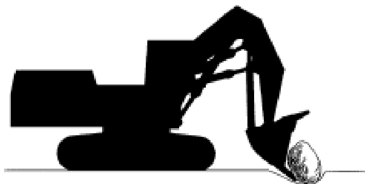
11.4-rasm. Ekskavator yordamida toshlarni surishning oqibatlari.
