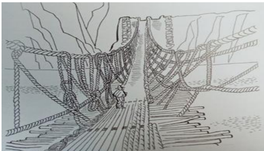
2.8-rasm. Inklarning arqondan tayyorlangan osma ko'prigi
