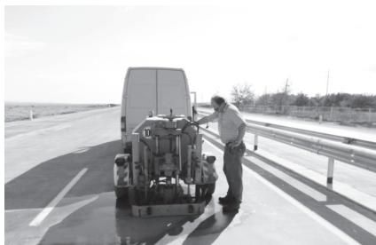
5.6-расм. Қопламадан диаметри 15 см ўлчамдаги цилиндрик керн намунасини бургулаб олиш жараёни.
