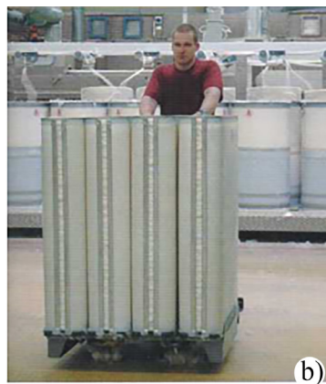
3.36-rasm. To‘g‘ri to‘rtburchak tazlarning avtomatik a) va qo‘lda b) transportirovkasi
