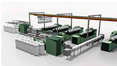
3.29-rasm. Xolstchalarni qayta tarash mashinalariga aravada qo'lda (chapda) va avtomatik (o'ngda) transportirovkalash
