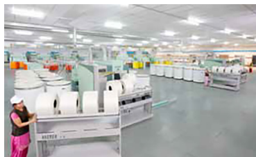
3.29-rasm. Xolstchalarni qayta tarash mashinalariga aravada qo'lda (chapda) va avtomatik (o'ngda) transportirovkalash
