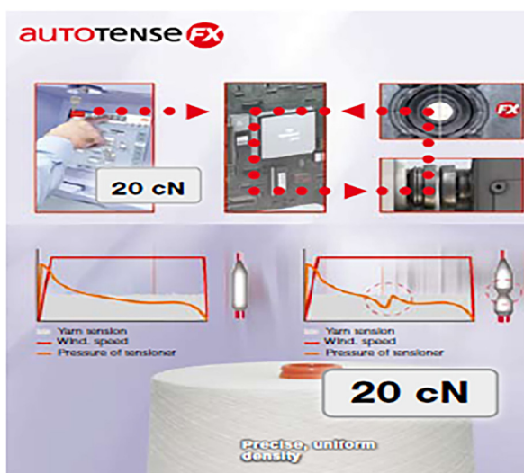
5.17-rasm. Autotense FX taranglikni rostlab ipni o'rash
