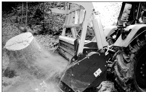
Рис. 3.7. Механизмы для срезки пней и кустарника: а – мульчер; б – кусторез
