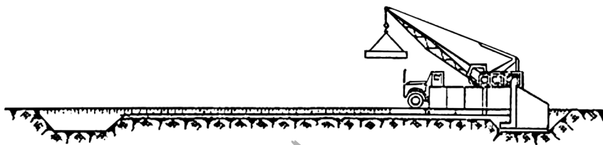
Рис. 4.5. Установка лекальных блоков и звеньев трубы
