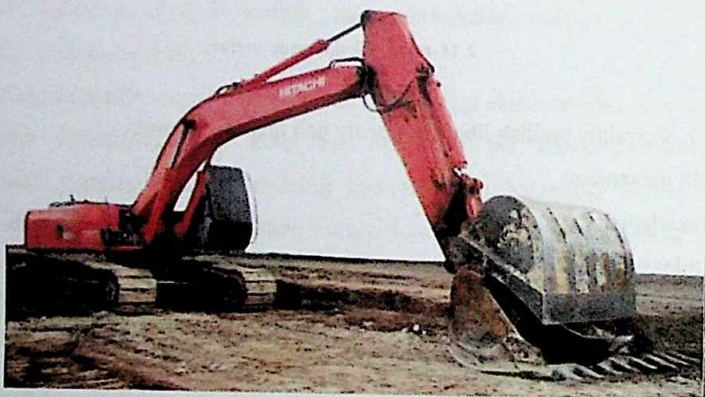
2.13- rasm. Ikki kovushli ekskavator.
