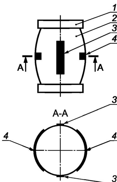
1 — опорная площадка; 2 — испытуемый образец; 3 — продольный тензорезистор; 4 — поперечный тензорезистор
