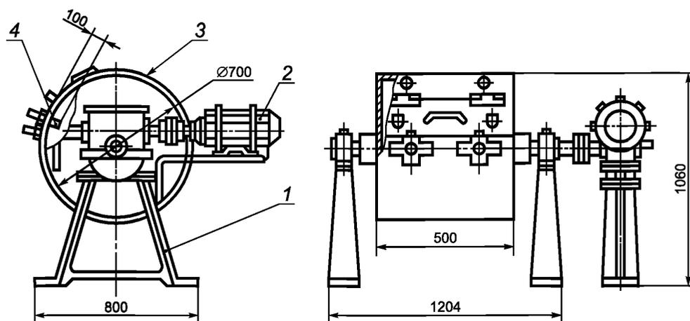
1 — станина; 2 — двигатель; 3 — барабан; 4 — полка барабана
