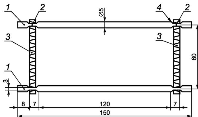
1 — металлические стержни диаметром 5 мм; 2 — места расточки стержней до диаметра 3 мм; 3 — резинка-продержка (или стальная пружина); 4 — места прошивки резинки
