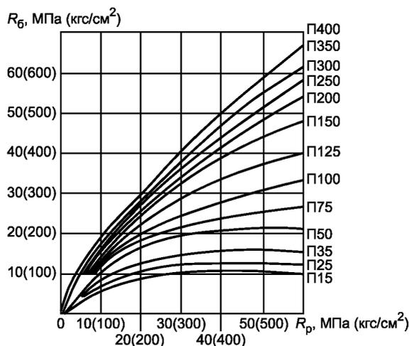
$R_б$  — прочность бетона;  $R_p$  — прочность раствора, отделенного от бетона
