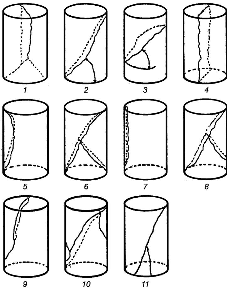
Рисунок E.4 — Неудовлетворительные разрушения образцов-цилиндров
