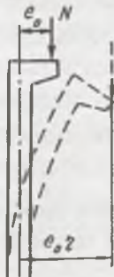
12.4-rasm. Egiluvchi elementlarda bo'ylama kuch yelkasining ortishi
