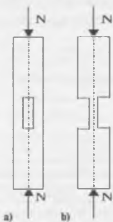
16.2-rasm. Markaziy siqiluvchi elementlar: a — qirraga chiqmagan o'yoq; b — qirraga chiqqan simmetrik o'yoq
