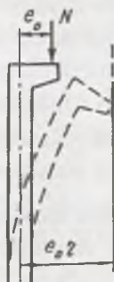
12.4-rasm. Egiluvchi elementlarda bo'ylama kuch yelkasining ortishi
