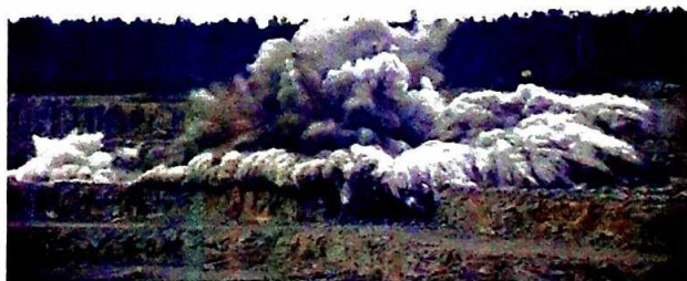
4.24-rasm. Noruda materiallar konlarini portlatish.
