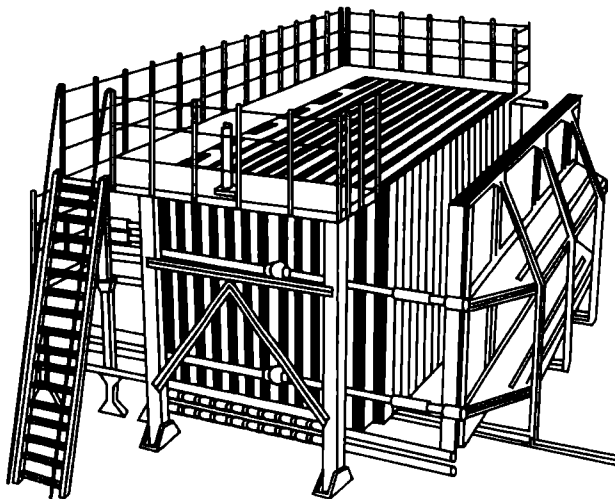
14.7-расм. Темир-бетон панеллар тайёрланадиган универсал кассета.
