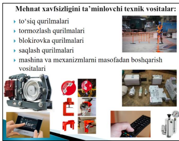
2.29. rasm. Mehnat xavfsizligini ta'minlovchi texnik vositalar
