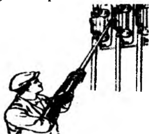
5.30– rasm. Tezkor himoyalovchi shtanga yordamida taqsimlash uskunalarida ayiruvchi pichoqlarni yoqish va o'chirish.
