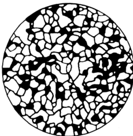
1.11-rasm. Kam uglerodli po'latning mikrostrukturasi.
