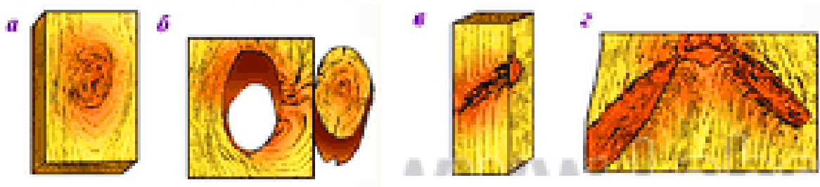
11.6-расм. Ёғочдаги кўзларнинг жойланиши. а-битиб кетган соғлом; б-етилмай қуриб қолган кўзлар; в-тўқима битилган кўзлар; г-тарқалган кўзлар
