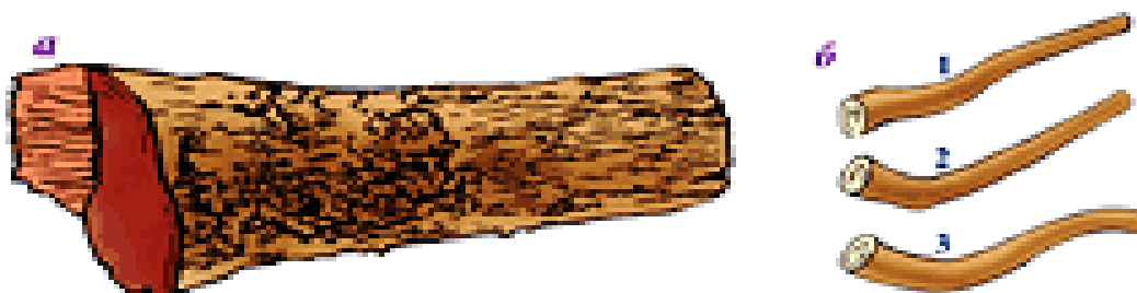
11.9-расм. Дарахт танасининг меъёрий шаклидан четланиши. а- тупсаланишлик; б-эгрилик (1, 2-оддий; 3-мураккаб).
