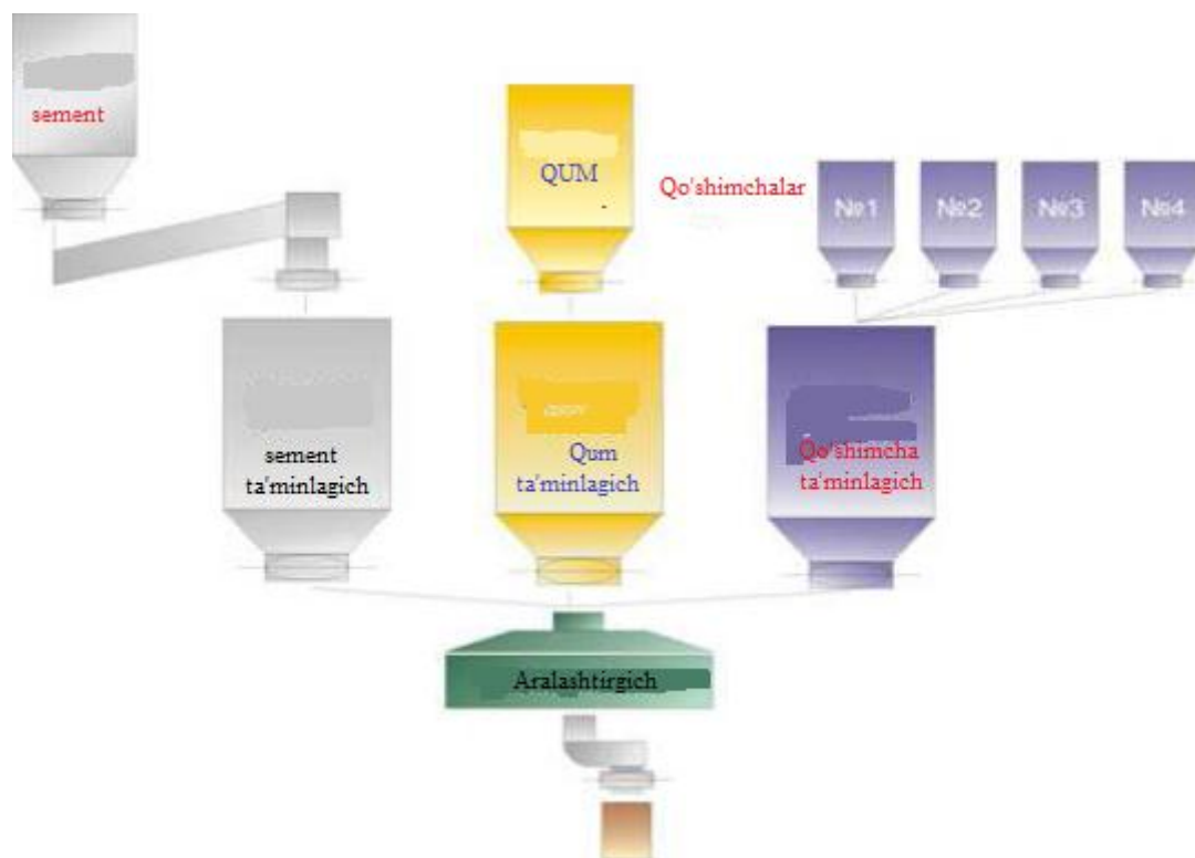
3.4-rasm. Quruq qurilish qorishmalarini ishlab chiqarish sxemasi
