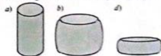
3.7-chizma. Po'lat namunaning siqilish jarayoni.
