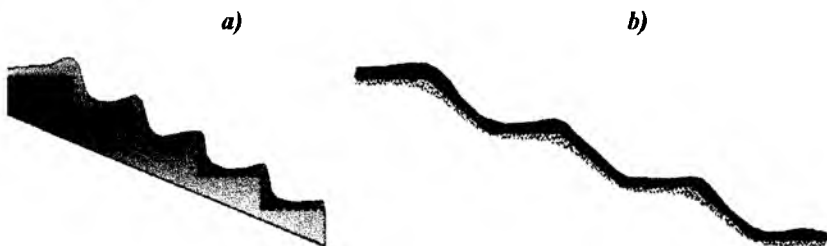
49-rasm. Irrigatsiya tarmoqlaridagi sharshara (a) va tezoqarlar (b).
