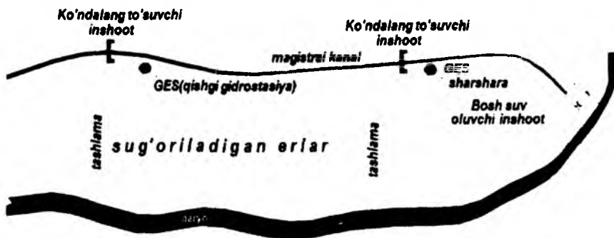
58-rasm. Tashlamalarga qurilgan yil davomida ekspluatatsiya qilinadigan GESlar sxemasi.
