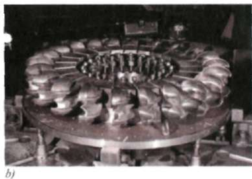
44-rasm. Osilgan (a) va yotqizilgan (b) cho'michli ish g'ildiraklari.
