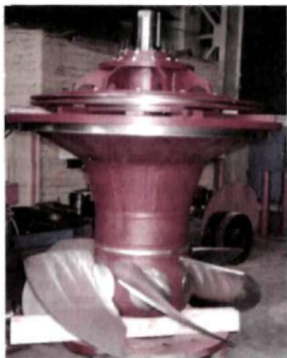
36-rasm. Parrakli turbina rotorining yig'ilgan holatdagi ko'rinishi.
