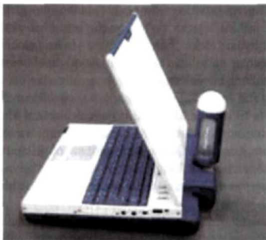
88-rasm. Vodorod yoqilg'isida ishlaydigan batareyaga ulangan noutbuk.
