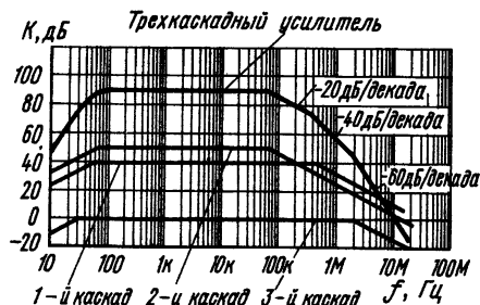
Рис. 2.38. Логарифмическая АЧХ трехкаскадного усилителя
