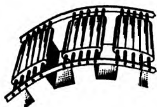
Рис. 9.26 Фрагмент продольно-поперечной демпферной обмотки генератора
