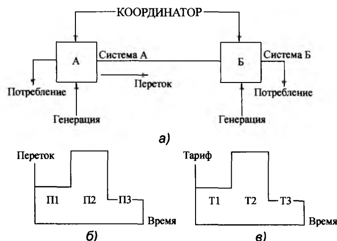
Рис. 11.6 Иллюстрация разницы между координацией по перетоку и координацией по тарифу
