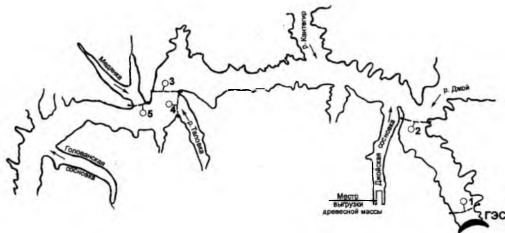
Рис. 5.22 Схема запаней, установленных на водохранилище Саяно-Шушенской ГЭС
