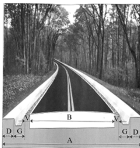
A-yo'lning butun eni; B-qatnov qismi; V-yo'l yoqasi; G-xandaqlar; D-trotuar
