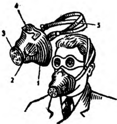
4-rasm. Resperator R-2: 1-yarim niqob; 2-nafas olish klapani; 3-nafas chiqarish klapani; 4-burun qisqichi; 5-tasmalar
