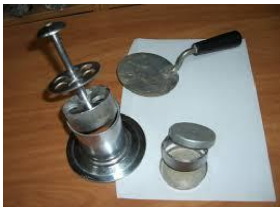
Ichki diametri 50 mm dan kam bo'lmagan metall keskich halqa va grunt olgich dastgohi
