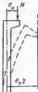
12.4-rasm. Egiluvchi elementlarda bo'ylama kuch yelkasining ortishi
