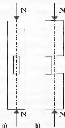
16.2-rasm. Markaziy siqiluvchi elementlar: a — qirraga chiqmagan o'yi; b — qirraga chiqqan simmetrik o'yi
