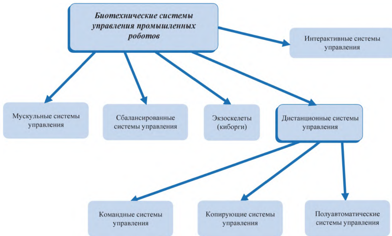
Рис. 1.17. Классификация биотехнических систем управления промышленных роботов
