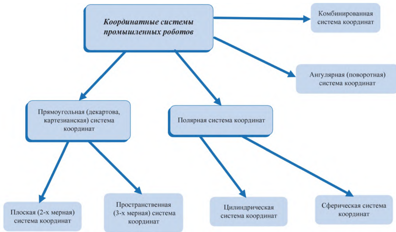
Рис. 1.2. Классификация промышленных роботов по координатным системам
