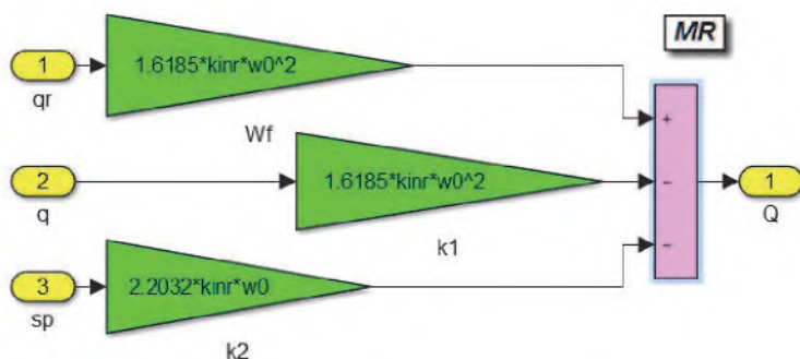
Рис. 7.8. Структура подсистемы модального регулятора положения
