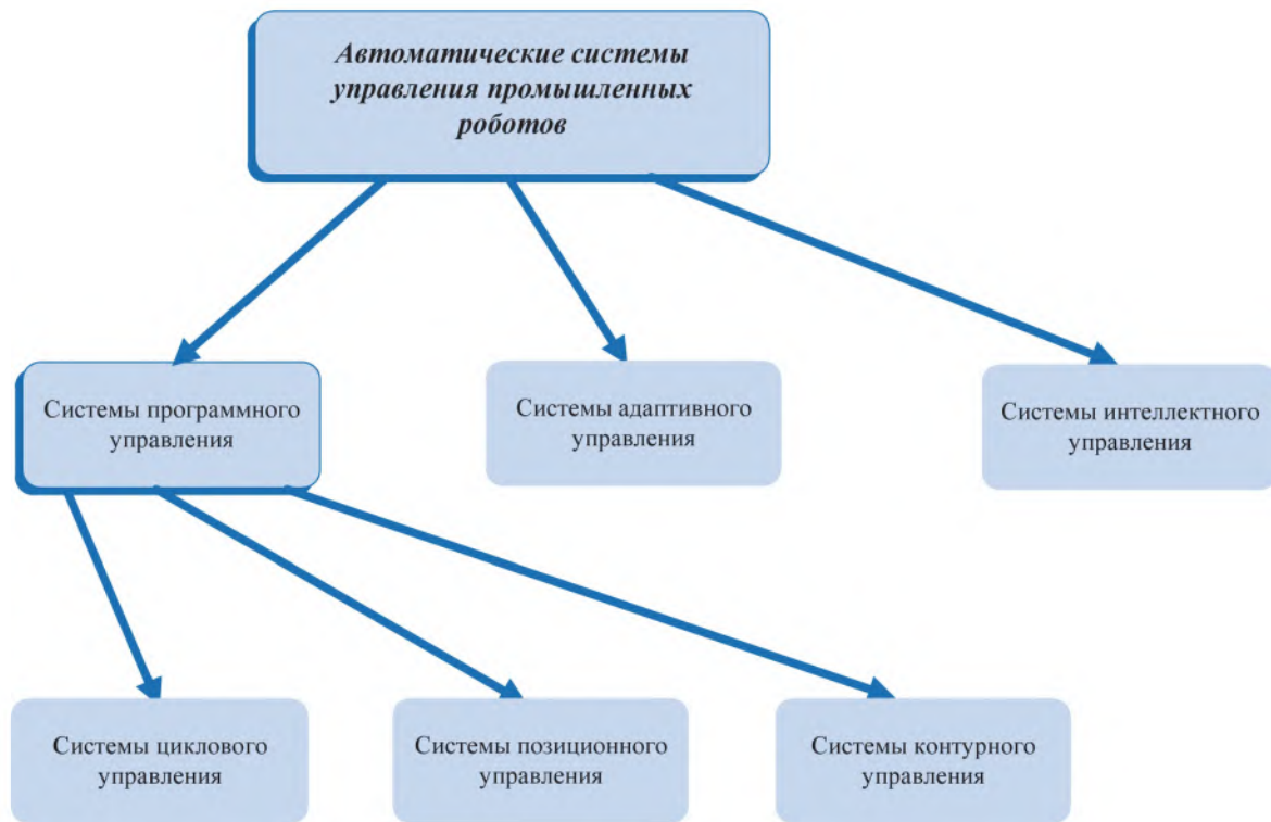
Рис. 1.18. Классификация автоматических систем управления промышленных роботов
