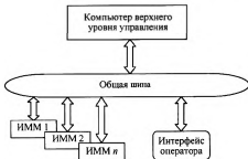
Рис. 3.15. Типовая архитектура распределенной системы управления
