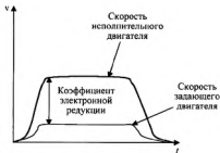
Рис. 2.15. Система управления движением на основе метода электронной редукции
