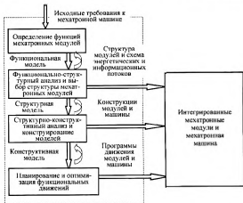
Рис. 2.4. Процедура проектирования интегрированных мехатронных модулей и машины
