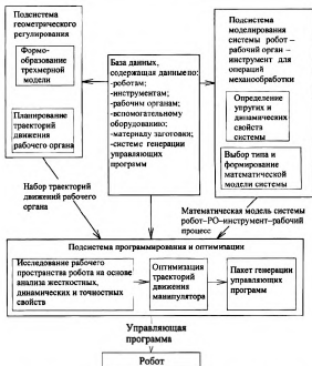
Рис. 4.7. Система автоматизированного программирования движений технологического робота
