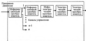
Рис. 2.11. Функциональная модель традиционной системы управления манипулятора "PUMA-560"
