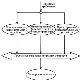
Рис. 2.3. Алгоритм параллельного проектирования мехатронных систем
