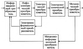
Рис. 2.6. Функциональная модель мехатронного модуля
