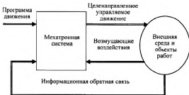
Рис. 2.5. Функциональное представление мехатронной системы
