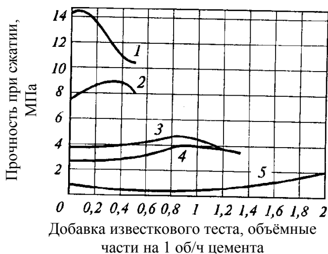
Рис. 8.2. Зависимость влияния дисперсных добавок (известь, глина) на прочность раствора. Цемент: песок (по объему): 1-1:3; 2-1:4; 3-1:5; 5-1:9.
