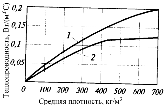
Рис. 14.1. Зависимость между средней плотностью и теплопроводностью теплоизоляционных материалов: 1-неорганические материалы; 2-органические материалы.
