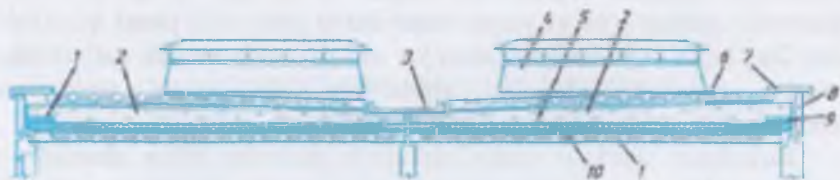
55-rasm. Qo'shaloq temir-beton qovurg'ali plitalardan iborat shamollatiladigan birlashgan tom:
