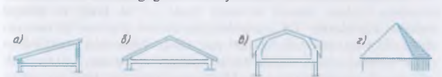
48-rasm CHordogli tomlarning aossiy turlari:
