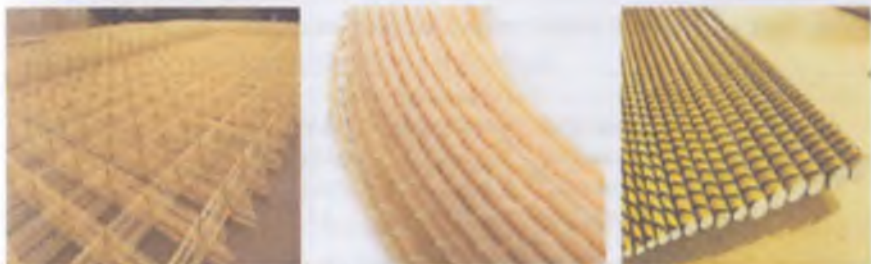
12-rasm. Shisha tolali kompozit armaturalar
