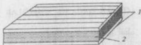
9.1-rasm. Ikki sirti suvga chidamli fanera bilan yopishtirilgan ko'pik-qatlam plita: 1 — suvga chidamli fanera, 2 — ko'pik-polistirol.
