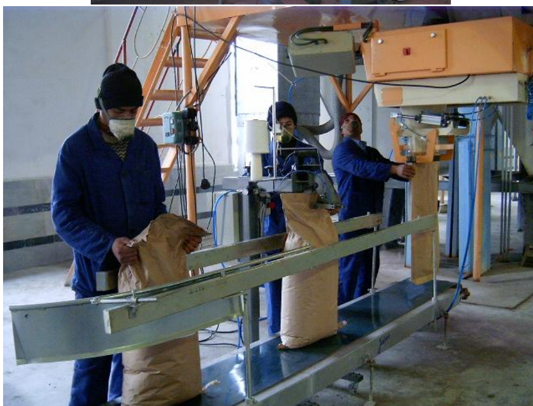
6.4.3-расм. Дориланган уруглик чигитни ўлчаб қадоқлаш ва қопларнинг оғзини тикиш жараёни амалга оширилмоқда
