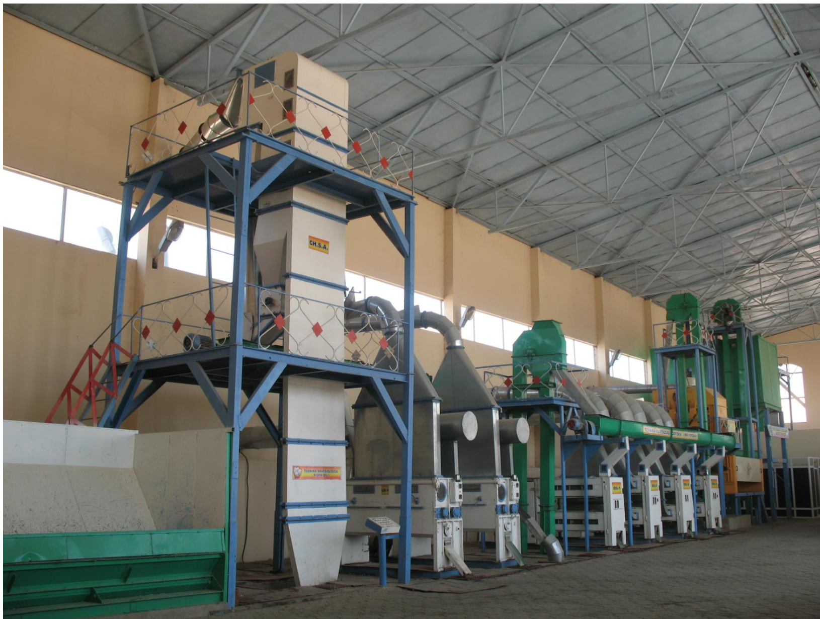
2.2.11-расм. Туксизлантирилган уруглик чигит тайёрлаш тизими
