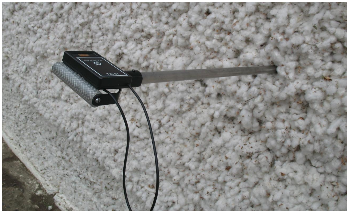
4-расм. ТШ-01 электрон ҳарорат ўлчагич ёрдамида ғарамдаги сақланаётган пахта хом ашёсини ҳароратини ўлчаш
