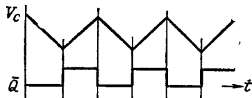
Рис. 2.19. Формы сигналов автогенератора по схеме рис. 2.18.
