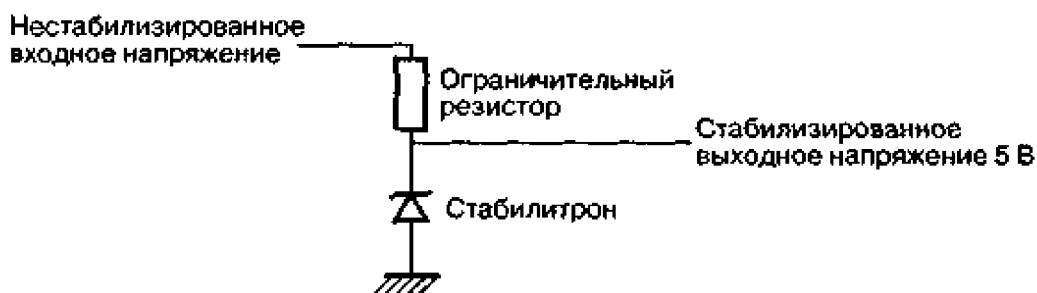
Рис. 3.19. Источник питания на стабилитроне
