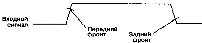
Рис. 3.29. Два уровня срабатывания триггера Шмитта
