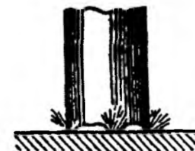
1.3.5- rasm. Qisqa tutashuv paytida elektrod uchining buyumga tegishi.
