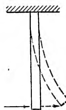
1.6.3- rasm. Elastiklikni tavsiflovchi deformatsiya (yuklama olingandan so'ng namuna o'zining dastlabki vaziyatiga qaytadi).
