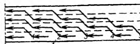
2.3.22- rasm. Uzun choklarni kaskad usulida ko'p qatlamli payvandlash sxemasi.
