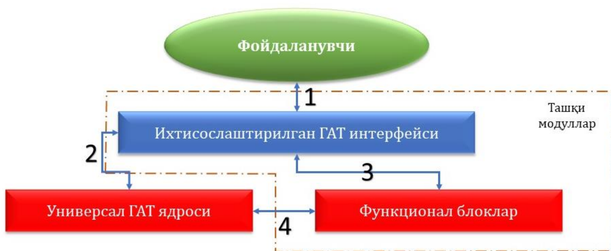
7.6-расм. Универсал ГАТ асосида яратилган ихтисослаштирилган ГАТларнинг дастурий таъминотининг умумий структураси
