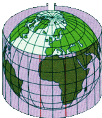
2.11-расм. Цилиндрик проекция.
