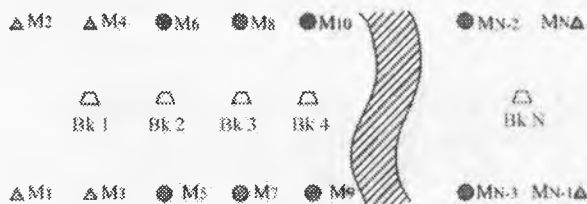
2.31-rasm. Skaner yo'lini o'tkazishda skanerli bekatlar va maxsus markalarning joylashish sxemasi:
