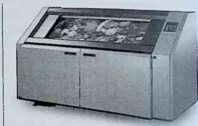
8.1.5-rasm. Raqamli ko'p bo'yoqli elektrografik bosma tizimi; imkonli qobiliyat 400 dpi gacha, havorang, qirmizi, sariq va qora rangli suyuq tonerlar; qo'shimcha tarzda maxsus bo'yoq yoki laklardan foydalanish mumkin, bosish tezligi 0,2 m/soniyagacha (bir nechta progonli tizim), nusxaning eni taxminan 1330 mm (Digital ColorStation 5442, Raster Graphics)
