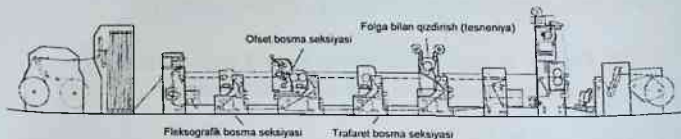
9.2.6-rasm. Fleksografik, ofset va trafaret bosma, shuningdek, zar bilan qaynoq qisish relefli qisish texnologiyalarini birlashtirgan, etiketkalarni bosishga mo'ljallangan gibrid bosma tizimi (CombiPrint, Goebel)
