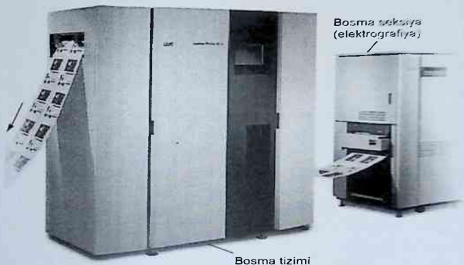
9.2.8-rasm. Elektrofotografiya (bir rangli rulonli bosish) va ko'p bo'yoqli nusxalar uchun purkashli bosma texnologiyalarini birlashtirgan gibril bosma tizimi (Info Print 4000; Info Print Highlight Color; IBM)
