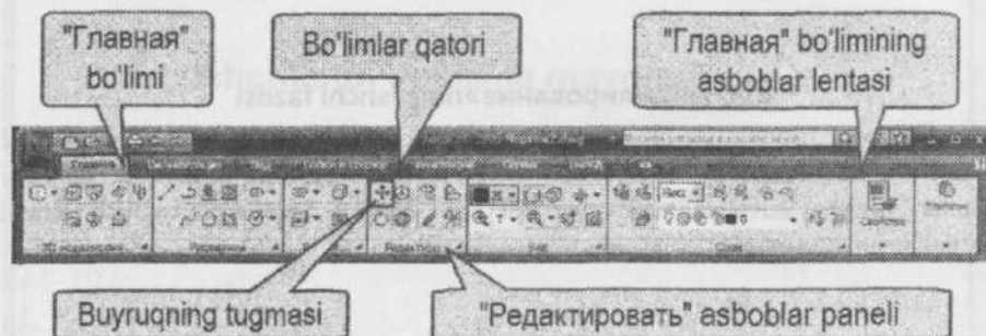
2.5-rasm. «3D моделирование» ishchi fazosidagi «Главная» bo'limining asboblardan lentasi.
