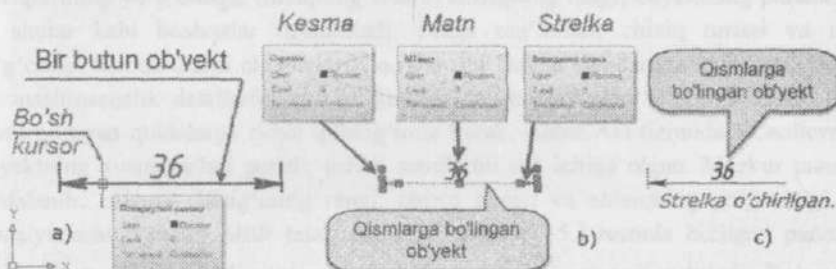
4.61-rasm. O'lchamni qismlarga bo'lish jarayoni.
