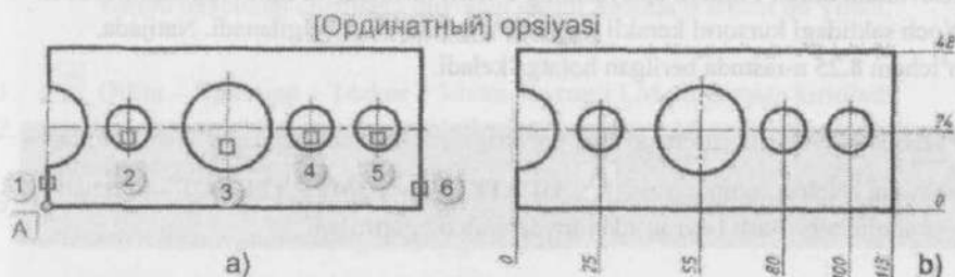
8.24-rasm. Ordinata o'lcham qo'yish jarayoni.
