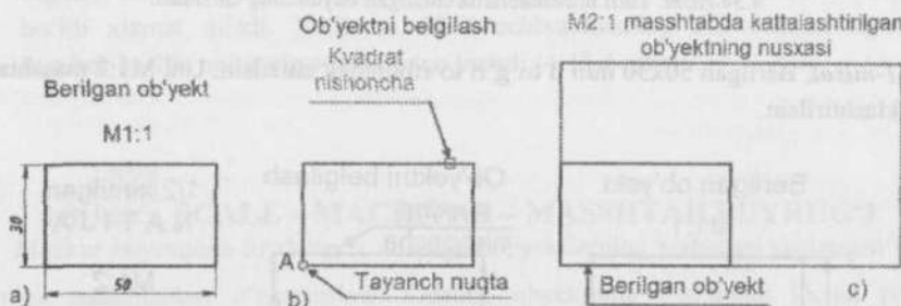
4.36-rasm. Копия opsiyasidan foydalanib, tanlangan obyektning kattalashtirilgan M2:1 masshtabdagi nusxasini olish jarayoni.
