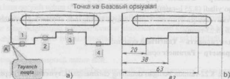
8.23-rasm. Tayan ch nuqtaga nisbatan chiziqli o'lcham qo'yish jarayoni.
