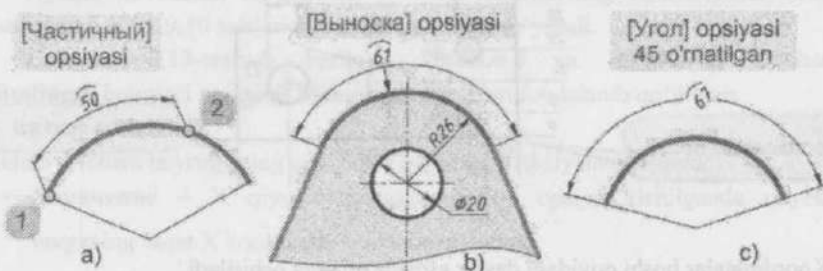
8.12-rasm. Частичный, Выноска va Угол opsiyalaridan foydalanib qo'yilgan yoyning uzunliklari.
