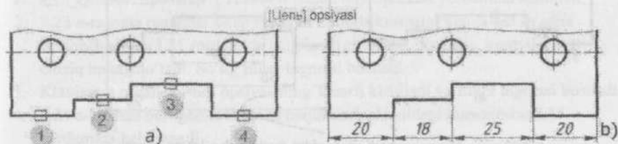
8.21-rasm. Zanjirli o'lcham qo'yish jarayoni.
