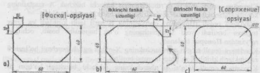
3.27-rasm. [Фаска] va [Сопряжение] opsiyalaridan foydalanib to'g'ri to'rtburchak chizish.
