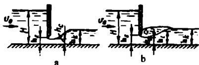
4.6-rasm. Diafragmali rostlagichlarning hisobiy sxemalari: a-ko'milmagan oqib chiqish bilan; b-ko'milgan oqib chiqish bilan.
