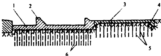
8.6-rasm. Pastki biefni mustahkamlash varianti: 1 - suv urilma; 2 - suv urilma devor; 3 - risberma; 4 - tish; 5 - shaxmat tartibda joylashgan ankerlar.
