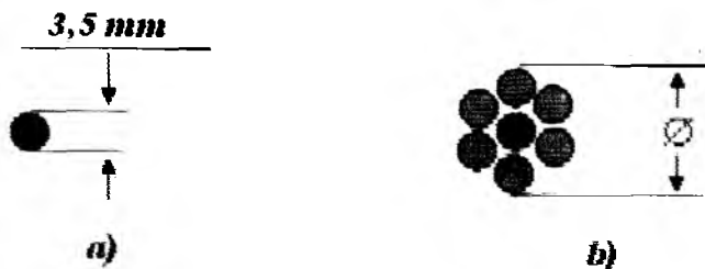
18.2-rasm. Aluminiiy-po'lat sim o'tkazgichning konstruktiv tuzulishi: a) bir simli po'lat o'tkazgich; b) aluminiiy po'lat (AS) o'tkazgich.
