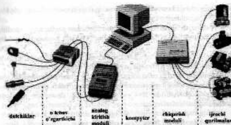
8.7-rasm. Bitta kiritish va bitta chiqarish qurilmasiga ega bo'lgan oddiy avtomatlashtirilgan tizimni bitta kompyuter orqali boshqarish sxemasi.
