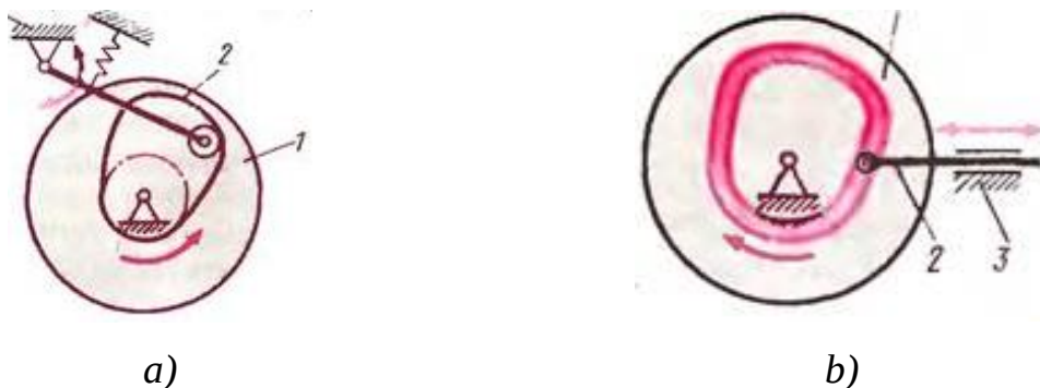
7.5-rasm: a) kuch yordamida tutashuv; b) kinematik (geometrik) tutashuvli kulachokli mexanizmlar.
