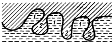
7.25-rasm. Suvlanish tillari (S.t.) va tegilmagan neft qoldiqlarining joylashish sxemasi 1- suvlanish tillari; 2 – tegilmagan neft qoldiqlari
