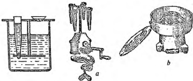
17-rasm. Sentrifugal: a – qo'l bilan ishlaydigan; b – elektr toki bilan ishlaydigan.
