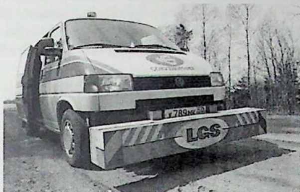
2.12-rasm. Avtomobilga o'rnatilgan LGS uskunasi
