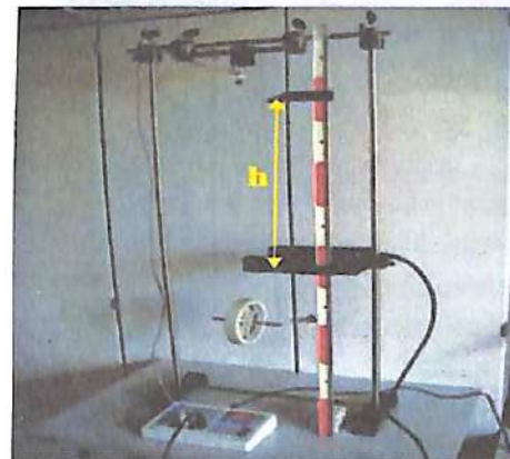
31-rasm: Maksvel diskilari yordamida energiya saqlanishi qonunini tekshirish uchun mo'ljallangan tajriba qurilmasi
