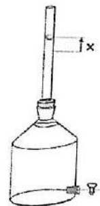
55-rasm. Richard metodi bilan adiabat ko'rsatkichini aniqlash uchun tajriba qurilmasi
